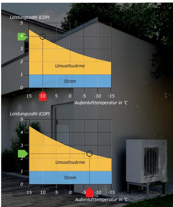
Abb. 3: Effizienz einer Luft-Wasser-Wärmepumpe
