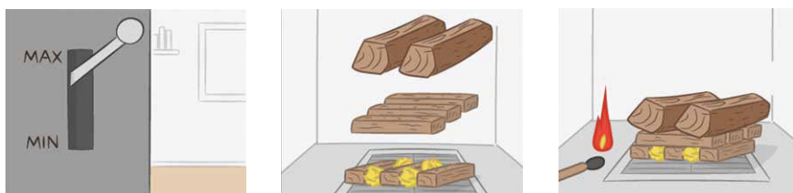
1. Luftzufuhr öffnen 2. Befuerungselement unter dem Scheitholz positioniert 3. Zündmittel entzünden
