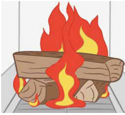
Das Feuer hat die gesamte Holzmenge erreicht. Drosseln Sie nun die Luftzufuhr.
